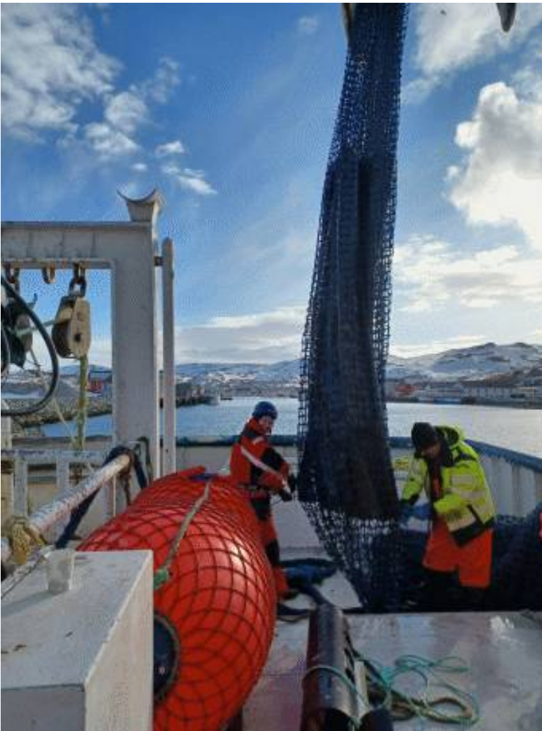
Figur 16 Svart presenning i kvadratmaskeforlengelse.
